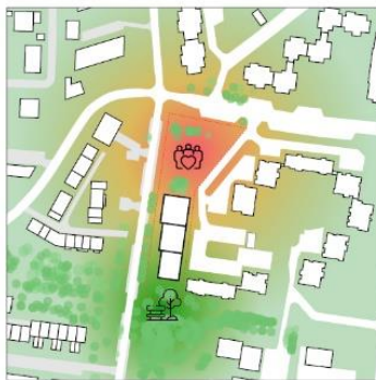
Darželis - bendruomenės centras Kompaktiškas darželio tūris atraukiamas į pietinę sklypo dalį, didžiąją jo erdvę užleidamas jau besimezgančiai vietos bendruomenės erdvei. Čia, žemiausioje sklypo dalyje, greta pagrindinių gatvių susikirtimo formuojama aktyvi žaidimų ir sporto zona, jungianti tiek pastato, tiek ir aplinkinių gyventojų bendruomenes. Tuo tarpu pietinė sklypo dalis gausiau želdinama ir natūraliai sujungiamą su greta esančio parko erdve.
