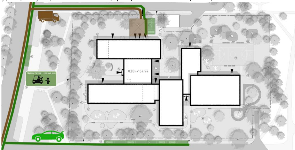
Automobilių judėjimo schema (žalia spalva – tėvelių ir mokytojų transportas, ruda spalva – aptarnaujantis transportas)
